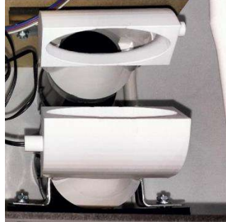
Figura 15.- Doble salida de aire para el secado de pies por la parte superior e inferior, fuente propia.
