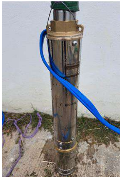
figura 8: bomba de 300 W utilizada para el funcionamiento del sistema de riego
