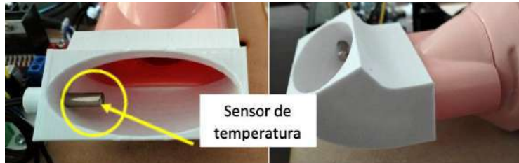
. Figura 12.- Boquilla de redireccionamiento de aire con sensor de temperatura, fuente propia.
