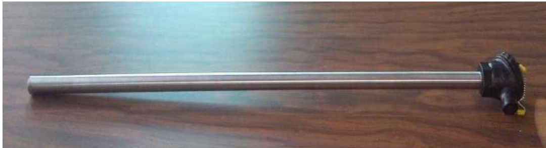
Figura 6. Termopozo fabricado de acero inox AISI 310 sin recubrimiento
