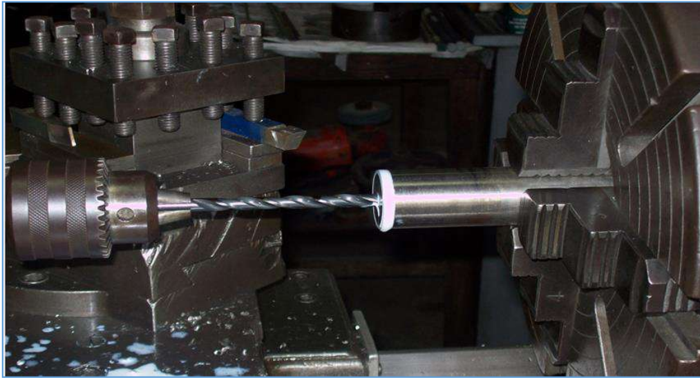
Figura 5. Maquinado de termopozo
