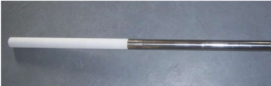
Figura 8. Termopozo de acero inox AISI 310 con recubrimiento.
