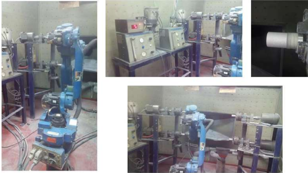
Figura 7. Equipo automatizado de plasma spray utilizado para el recubrimiento
