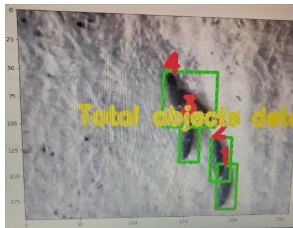
Figura 11 Resultaos usando la técnica se segmentación por HSV
