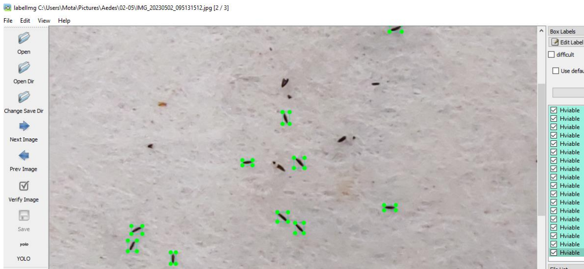
Figura 5 Etiquetado de objeto Huevo viables usando labelImg
