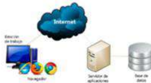
Figura 2. Esquema de la arquitectura que soporta la aplicación web
